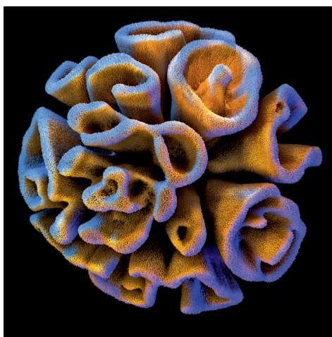
FIGUUR S1: Zelfgeassembleerde microarchitectuur bestaande uit \text{BaCO}_3 nanokristallen en amorfe \text{SiO}_2 (structuurbreedte: 26 \mu\text{m} ).
